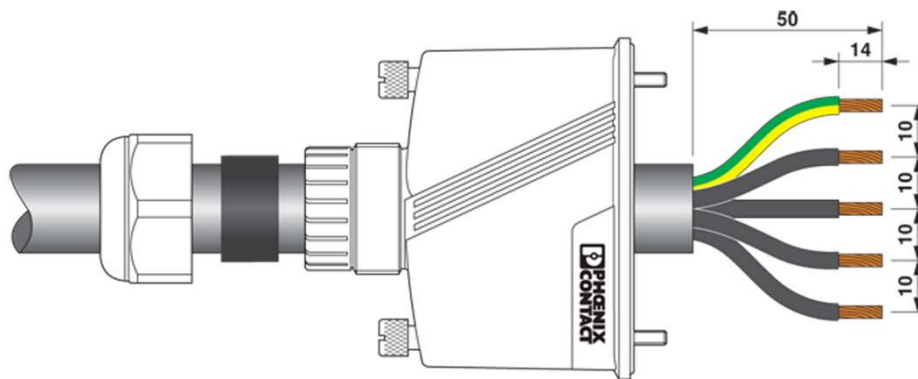
Bild 12: Vorbereitung Steckerkabel
