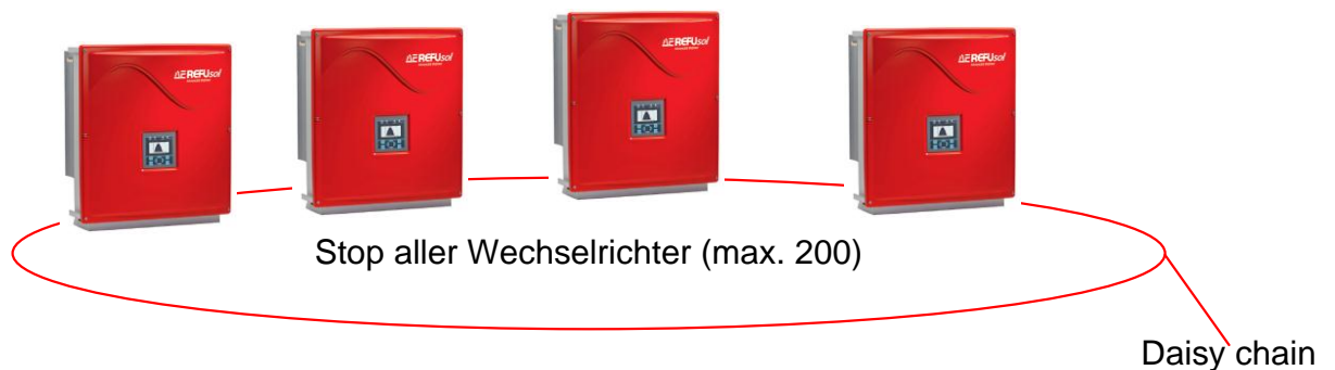
Bild 31: Externes Abschaltsignal innerhalb der „Daisy chain“
